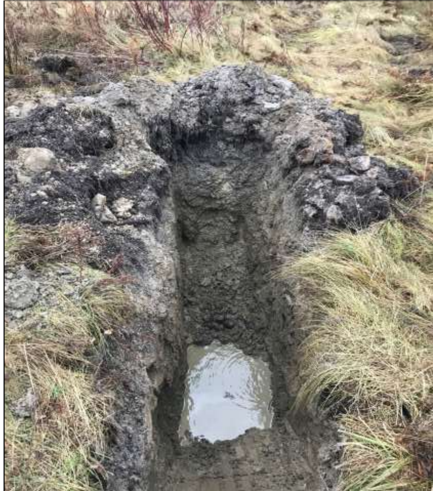
PHOTO #4: Puits d'exploration PE-3-18: Terrain naturel Sols organiques; Silt et sable, un peu de gravier; Shale Venue d'eau moyenne à 1,50 m
