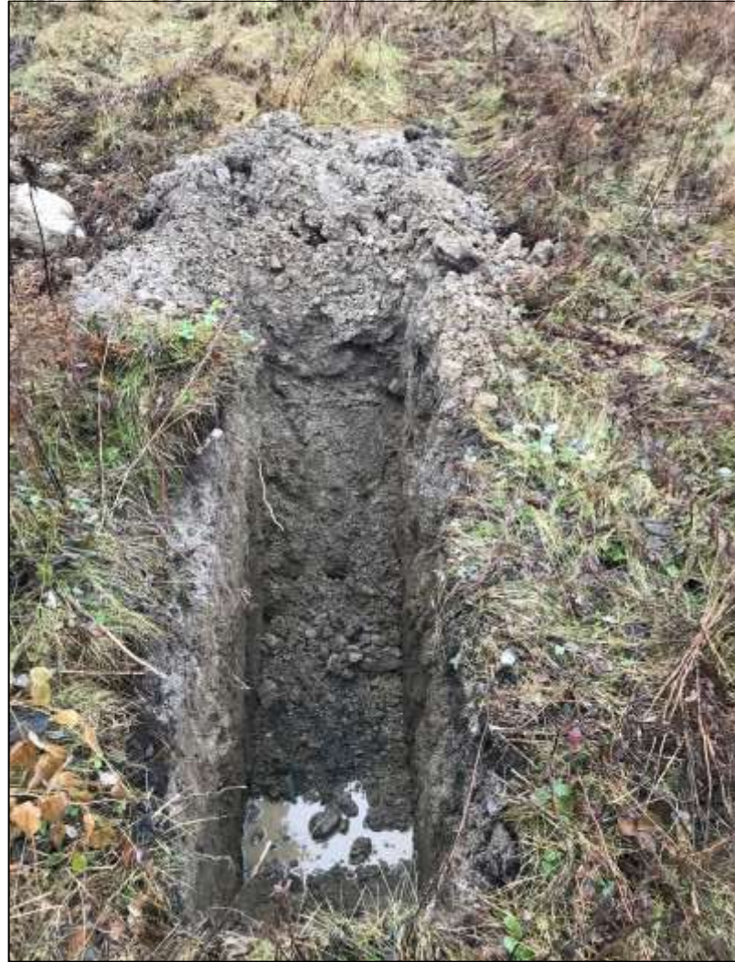
PHOTO #6: Puits d'exploration PE-5-18: Terrain naturel Sols organiques; Silt et sable, un peu de gravier; Shale Venue d'eau moyenne à 1,30 m
