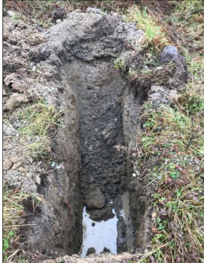
PHOTO #8: Puits d'exploration PE-7-18: Terrain naturel Sols organiques; Silt et sable, un peu de gravier; Shale Venue d'eau moyenne à 1,30 m
