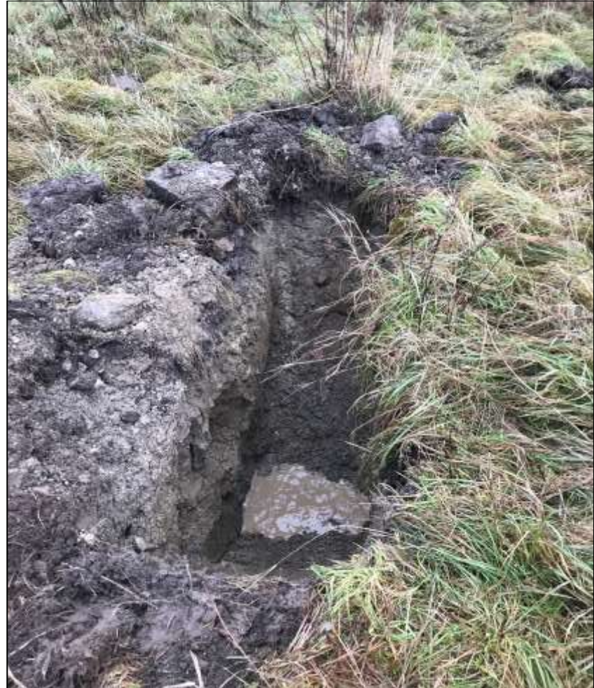
PHOTO #2: Puits d'exploration PE-1-18; Terrain naturel: Sols organiques; Sable et silt graveleux; Shale Venue d'eau moyenne à 1,50 m
